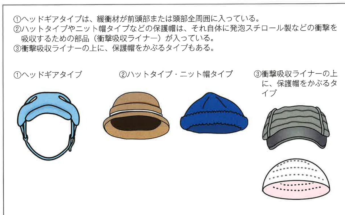
図4 保護帽のタイプと構造
