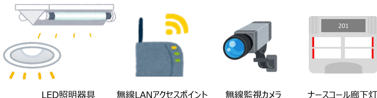
図 23 医用テレメータへ干渉を与えるおそれのある機器の例
